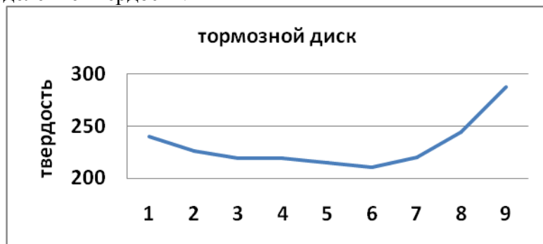
Рисунок 4 – Изменение твердости в тормозном диске с повреждениями
