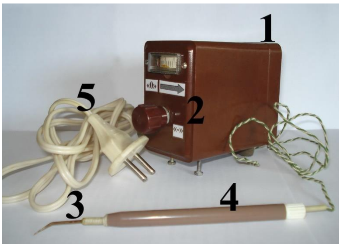
Рисунок 1. «Термоигла» – уникальный прибор, состоящий из блока питания (1), нагревательного элемента (2), иглы (3), ручки (4) и электрического шнура с вилок (5)
